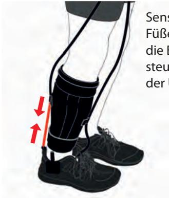
Sensoren an beiden Füßen analysieren die Bewegung und steuern das Timing der Unterstützung
