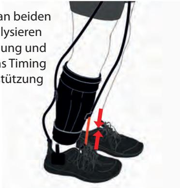
Kontraktion des vorderen Kabels zur Unterstützung der Dorsalextension um die Fußheberschwäche zu kompensieren
